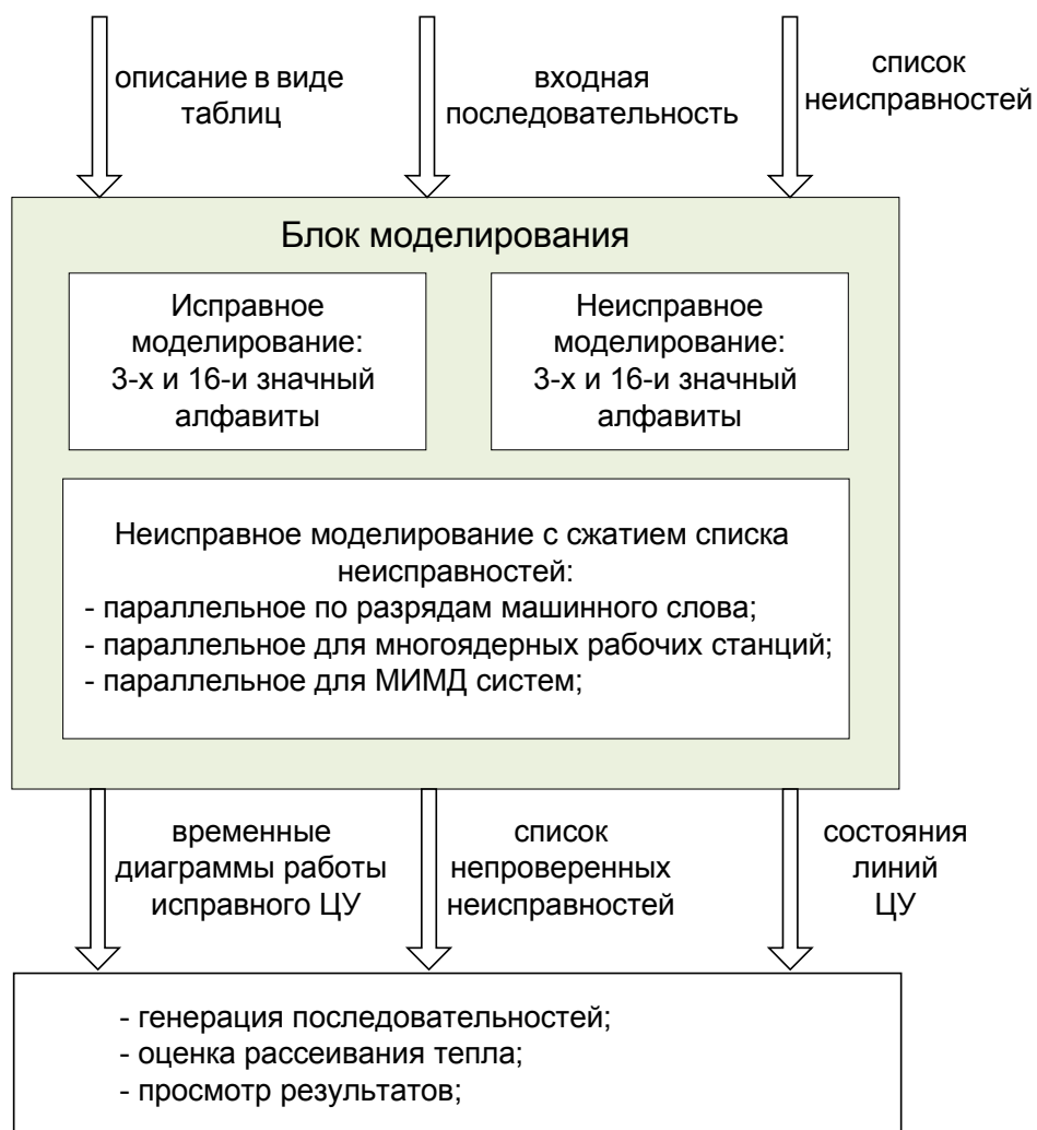
Рис.5.3. Подсистема моделирования и её входные/выходные потоки данных.
